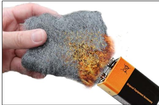
**Abb. 1: Stahlwolle wird mit Hilfe einer Batterie entzündet (© Schumann)**
