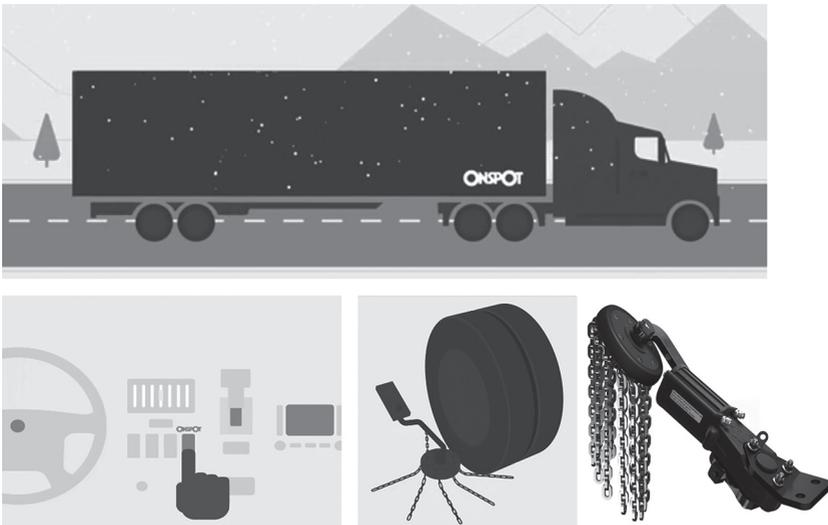
Abb. 1: Exemplarische Screenshots aus dem Technik-Stummfilm „Schleuderschneeketten“
