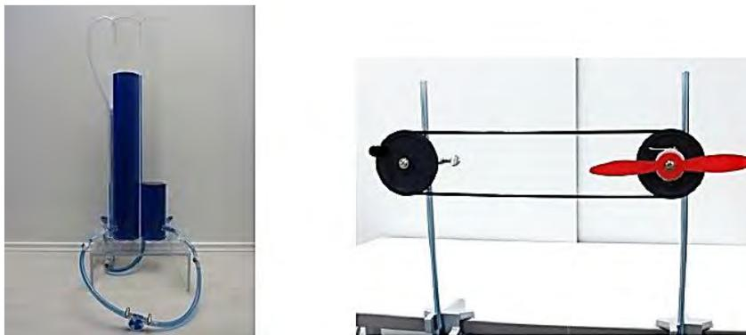
**Abb. 2:** Großes Wasser- und Riemenmodell für den Stromkreis
