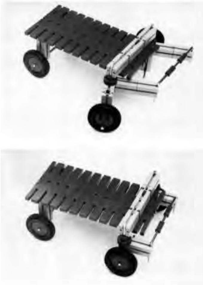
Abb. 12: Achsschenkel-Lenkung, aus der doppelten Drehschemel-Lenkung entwickelt.
